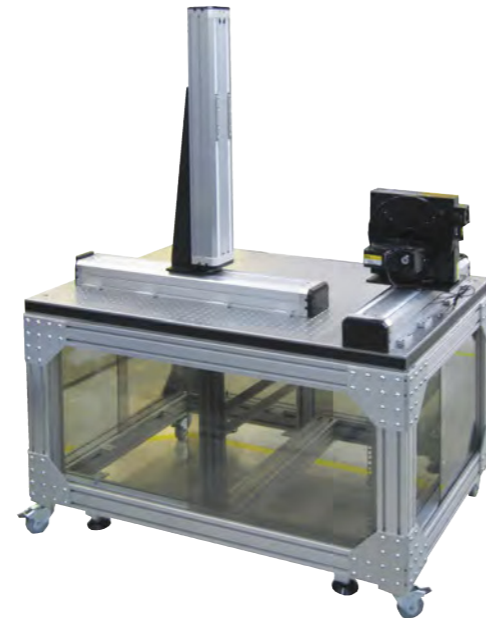
Estación de medición con Cubierta de Granito
